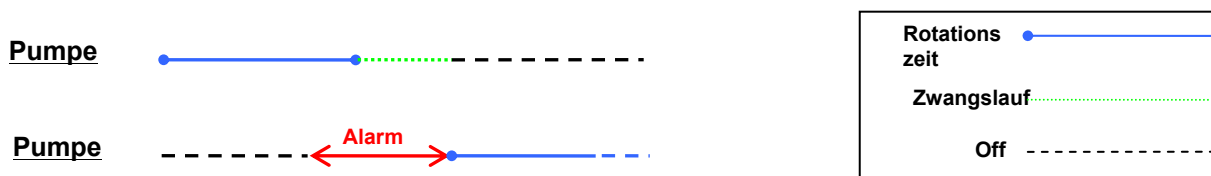
Abbildung 15: Pumpenrotation mit Alarm - 2
