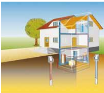
Anlagenschema - Förder- und Schluckbrunnen Wasser
