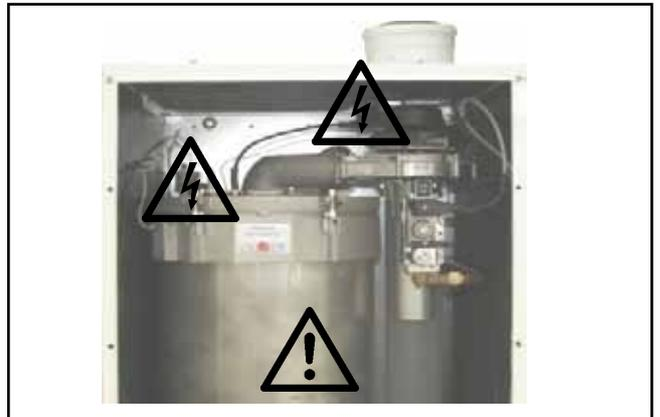
Bild: Zündtrafo, Hochspannungs-Zündelektrode, Wärmetauscher
