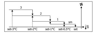
Bei den Konfigurationen mit 4 Geschwindigkeiten und Ventil wird die Belüftung im Heizbetrieb um 0,5°C verzögert, um eine erste Phase natürlicher Konvektion zu ermöglichen.
