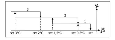
AUTOMATISCHER BETRIEB FÜR EINHEITEN MIT 4 GE-SCHWINDIGKEITEN UND MODULIERENDEM/-N VENTIL/-EN:
