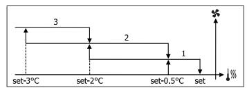
AUTOMATISCHER BETRIEB FÜR EINHEITEN MIT 4 GESCHWINDIGKEITEN UND ON/OFF-VENTIL/-EN (ODER NICHT VORHANDEN):
