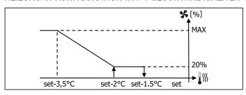
Bei den Konfigurationen mit 4 Geschwindigkeiten wird die Belüftung im Heizbetrieb um 0,5°C verzögert, um eine erste Phase natürlicher Konvektion zu ermöglichen.
